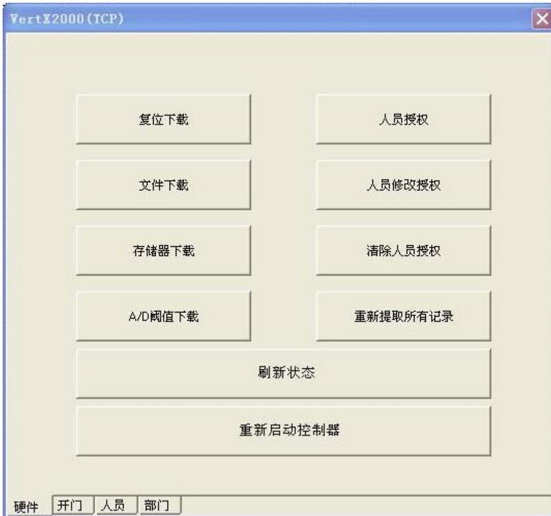
第一次对控制器参数进行配置时，必须选择[复位下载]，以后的参数修改就可以用[文件下载]来代替。对于时间参数的改变（如开门时间等）要用[存储器下载]；[A/D 阈值下载]是用来调节报警输入点报警的阈值。
