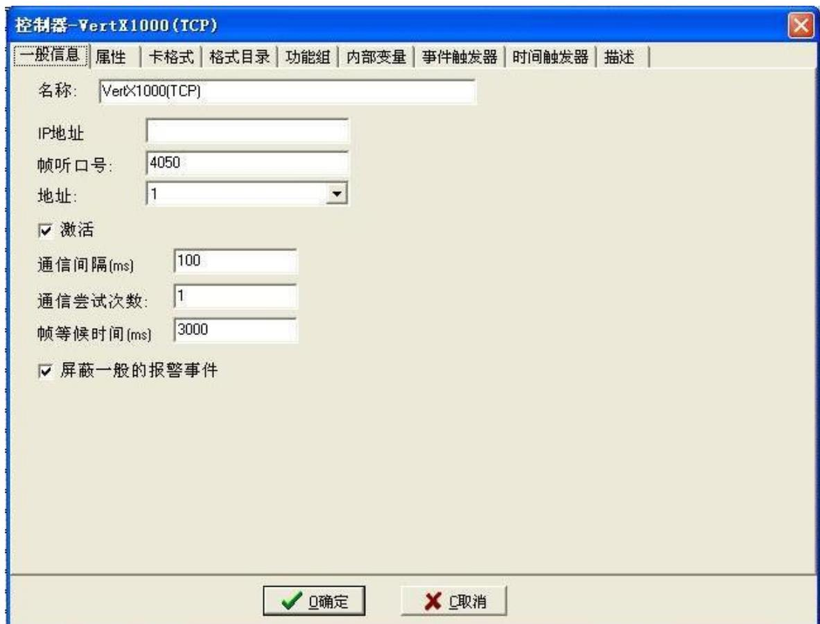
用户只需要输入 HID 控制器的 IP 地址就可以了，其它为默认配置，用户不需要修改，按确定完成配置。如果用户采用的是 V2000 控制器，读卡器将一并配置完成，如果是 V1000 控制器，还需要配置下面的 V100、V200 和 V300 模块。
