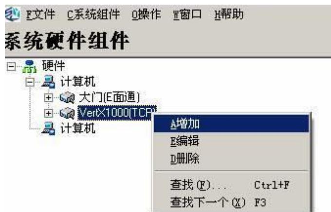
系统将根据不同的模块类型出现以下界面，在默认状态下，用户只需要修改控制器连接的口号和物理地址便可，这必须要求用户了解实际的物理连接。最后按确定完成模块的配置。
