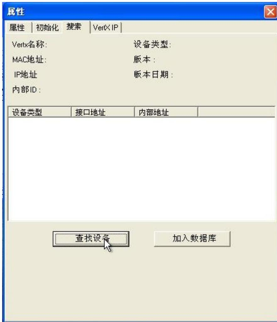
在重新启动设备后，可以选择[搜索]页,按查找设备能自动搜索到该设定的控制器，并会自动发现该设备下所挂接的 V100,V200,V300 模块。
